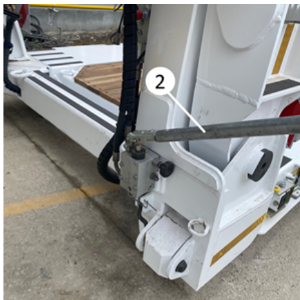
À utiliser comme poignée de pompe lors de l'utilisation de la pompe manuelle d'urgence (2)
