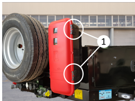
Armoire à extincteurs
