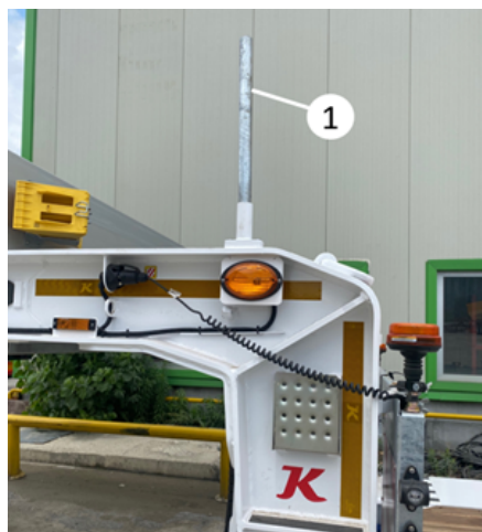
À utiliser comme poignée lors de l'ascension d'un col de cygne (1)
