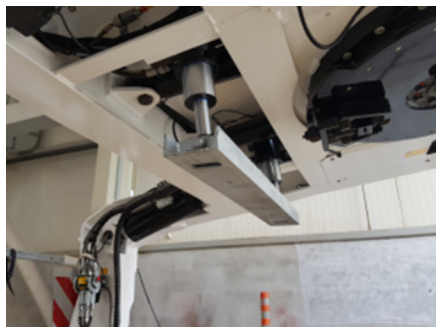
Abaissement de la console de débranchement du col de cygne
