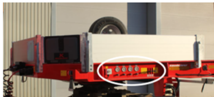
Position du panneau de commande
