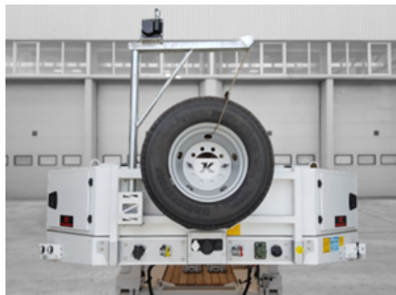
Treuil d'abaissement de la roue de secours
