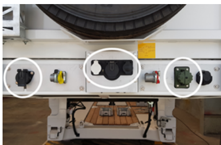
Emplacement des connexions électriques
