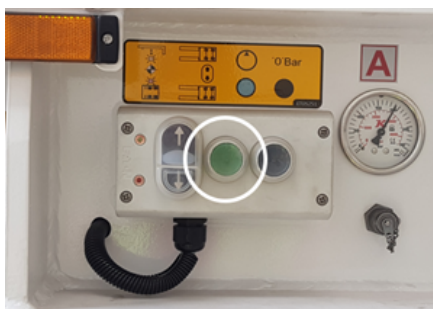
Bouton de démarrage de la pompe
