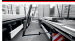
Erweiterung der mittleren Rungen
