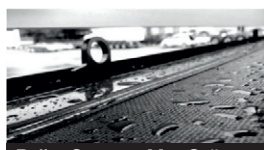
Pallet Stopper Met Geïntegreerde Lashing Ringen
