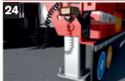
24 Zampe d'appoggio posteriore idraulico
