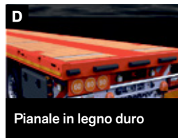
E Pianale in legno duro con profili omega
