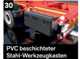
PVC beschichteter Stahl-Werkzeugkasten
