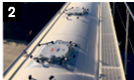
2 Manhole gedeelte niet gespoten
