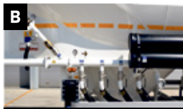
B Silo- spuitstuk dat niet kan kantelen
