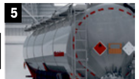
5 Drabiny i poręcze Electro Polerowana stal nierdzewna
