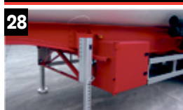
28 Aluminiowa podpora mechaniczna
