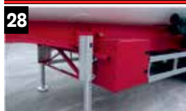
28 Aluminiowa podpora mechaniczna
