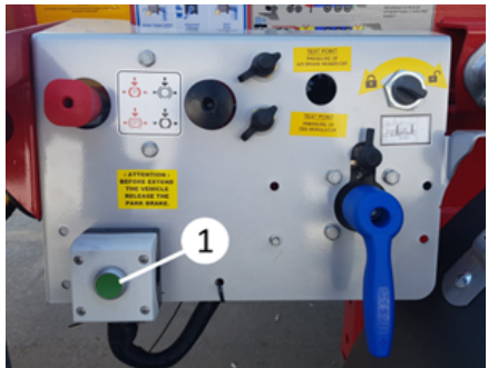
Botón del muelle en la placa del brazo
