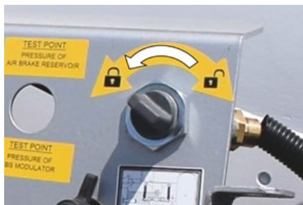
Cambio del bloqueo a la posición cerrada
