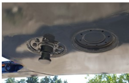
Posición del doble King Pin
