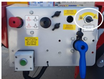
Posición del bloqueo de la extensión central
