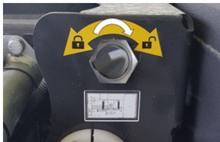
Desbloqueo del bloqueo de la extensión trasera
