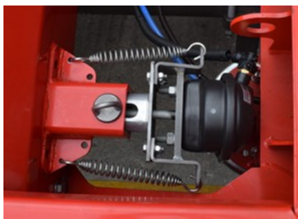
Estado de apertura de la válvula neumática
