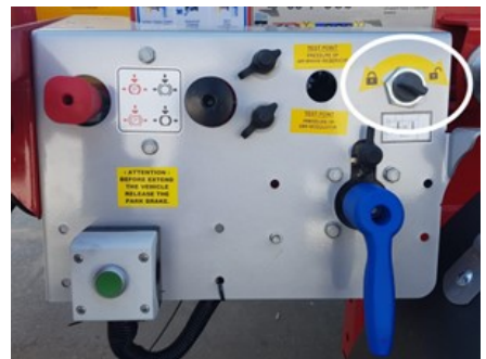
Posición del bloqueo de extensión central
