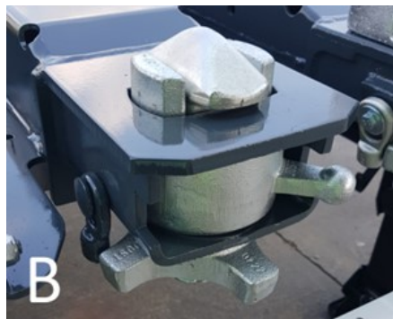
Posición de marcha en vacío
