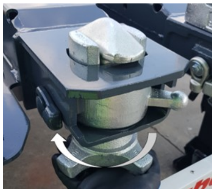
Aflojar la tuerca tensora
