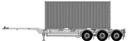
Transporte de un contenedor de 20 pies en el centro
