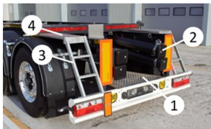
Porta contenedores cisterna - secciones de la zona trasera
