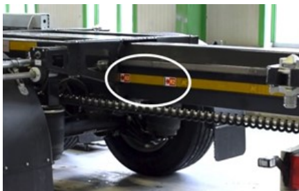
Etiquetado del tipo de contenedor en la plataforma
