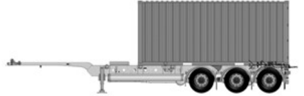
Transporte de contenedor de 20 pies en la parte trasera
