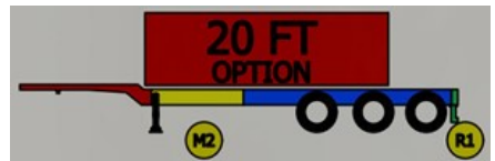
Transporte de contenedor de 20 pies en el centro
