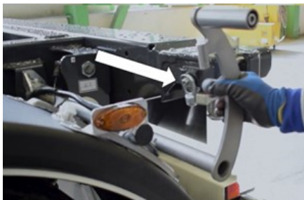
Tirar de la palanca de extensión
