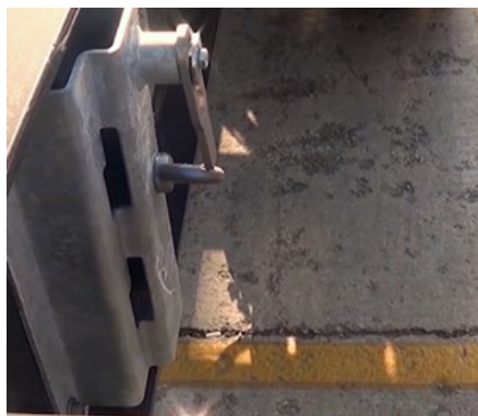
Ranura de almacenamiento de bloqueo del contenedor
