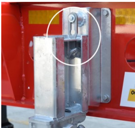
Inserción del pasador de seguridad de la ranura de almacenamiento
