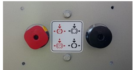
Botones de freno de estacionamiento y de servicio
