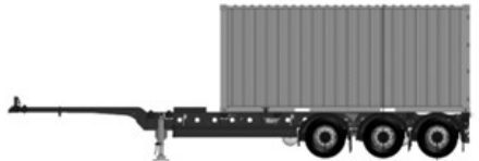
Transporte de contenedores de 20 pies en la parte trasera
