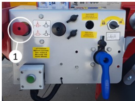
Freno de estacionamiento accionado por resorte
