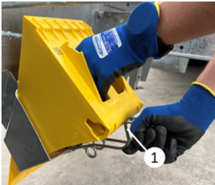
Extracción del calzo de la carcasa
