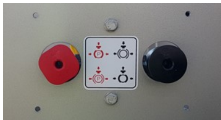
Botones de freno de estacionamiento y de servicio
