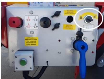
Posición del bloqueo de la extensión central
