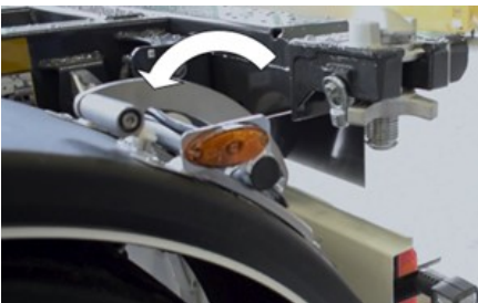
Colocación del brazo de extensión
