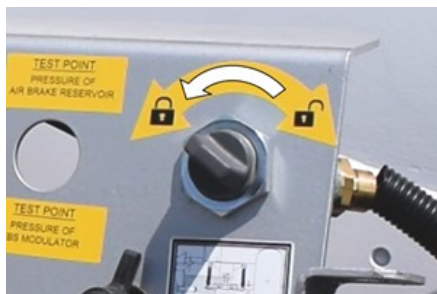
Cambio del bloqueo a la posición cerrada
