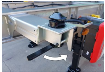
Giro del bloqueo del contenedor
