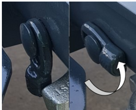
Giro del perno de seguridad 90°
