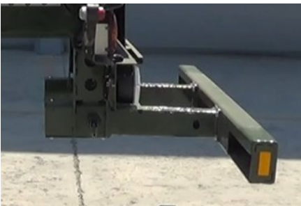
Versión extendida del parachoques extensible
