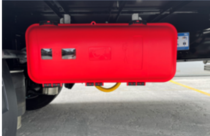
Armario para extintores
