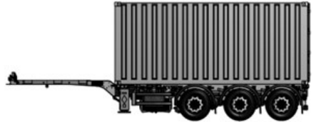
Transporte de contenedores de 20 pies en la parte trasera
