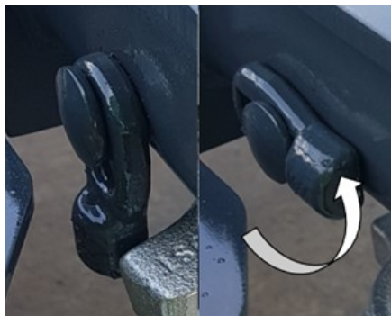
Girar el pestillo de seguridad 90
