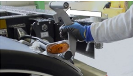
Empujar la palanca de extensión
