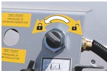
Cambio del bloqueo a la posición cerrada
