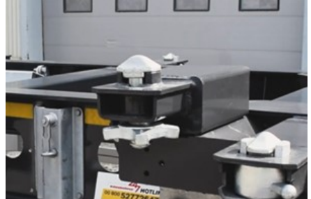
Colocación de bloqueo en la superficie superior
