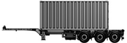
Transporte de un contenedor de 20 pies en el centro
