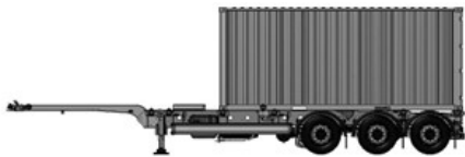
Transporte de contenedor de 20 pies por la parte trasera
