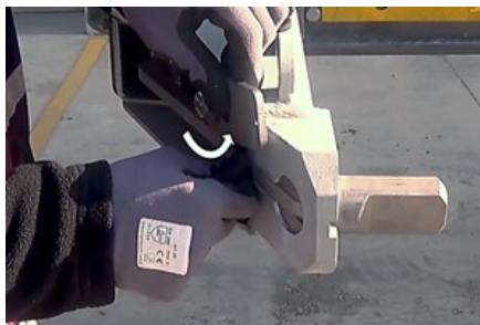
Levantar el pasador de seguridad
