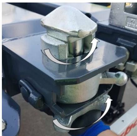
Volver a la posición de bloqueo
