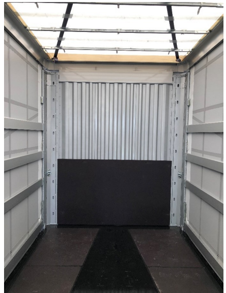
Estructura de madera contrachapada para protección contra impactosa
