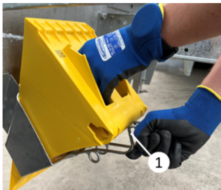
Extracción del calzo de la carcasa
