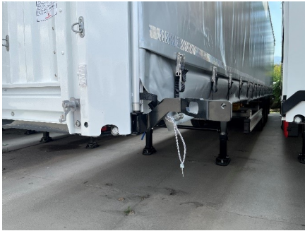
Tensado frontal abierto
