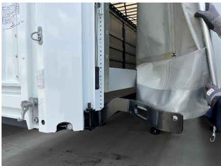
Desmontaje del tubo de la cortina
