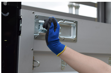
Bloqueo de la cubierta
