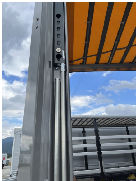
Barra de nivelación
