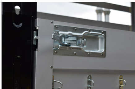
Bloqueo de la cubierta
