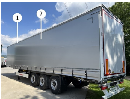
Estructura de cortina sin cubierta sin encolado
