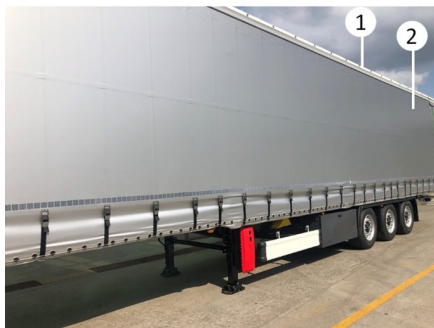
Estructura de cortina sin cubierta encolada
