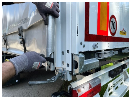
Desmontaje del perfil de la cortina
