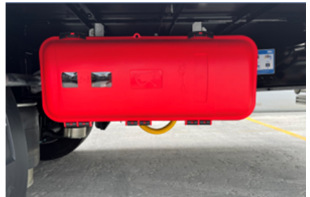
Armario para extintores
