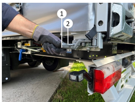
Tensado de la cortina
