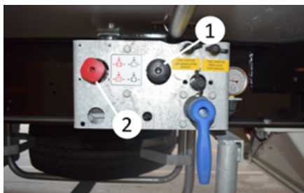
Elementos de mando de los frenos
