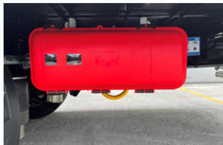
Armario para extintores
