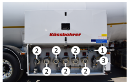
Armario de armadura
