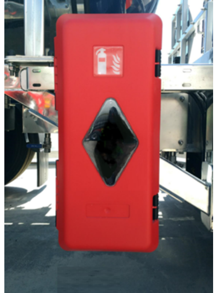
Caja del extintor
