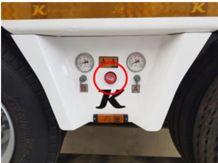
*Rote Taste für die Feststellbremse*
