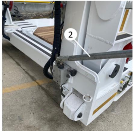
Verwendung als Pumpengriff bei Verwendung der Nothandpumpe (2)
