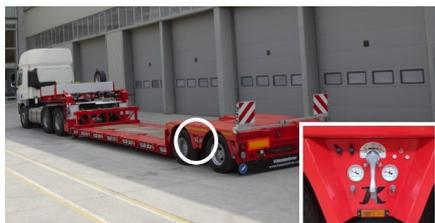
Lage des Absenk-/Hebeventils am Tiefladerfahrzeug
