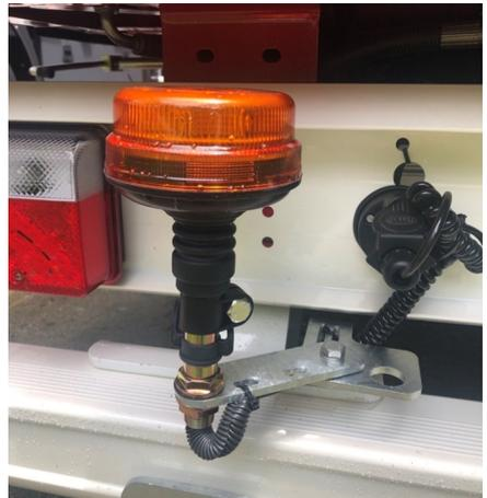
*Drehbare Warnlampe mit Led*
