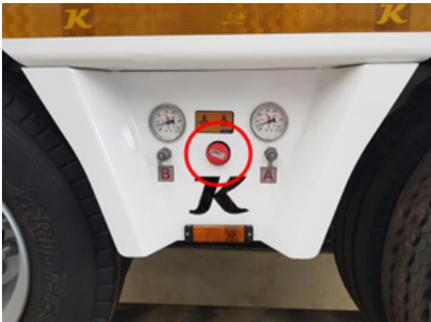
*Rote Taste für die Feststellbremse*
