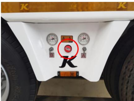
Rote Taste für die Feststellbremse
