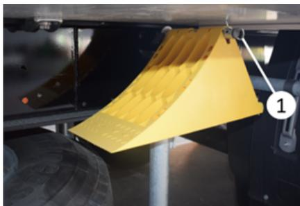
**Inserción de la montura en su alojamiento:** Después del uso, inserte el montaje en el pasador de retención del montaje y asegúrelo insertando el pasador de chaveta en su lugar.
