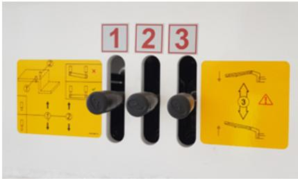
Palancas de control hidráulico
