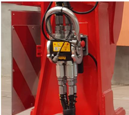
*Conexión hidráulica de acoplamiento rápido*
