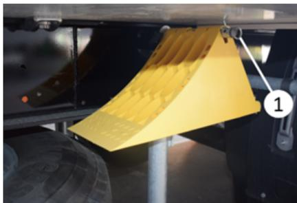
**Inserción de la montura en su alojamiento:** Después del uso, inserte el montaje en el pasador de retención del montaje y asegúrelo insertando el pasador de chaveta en su lugar.
