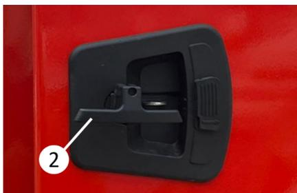
Extracción y rotación del pestillo de bloqueo
