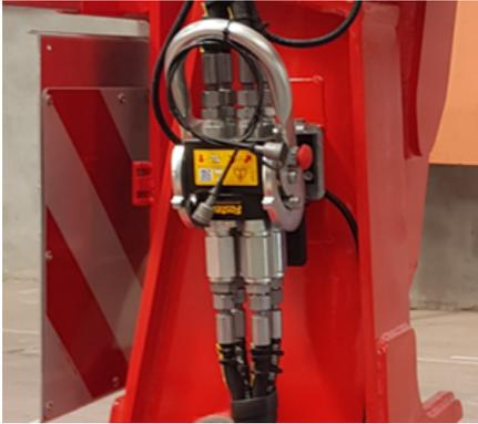
*Conexión hidráulica de acoplamiento rápido*
