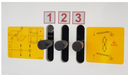
*Palancas de control hidráulico*
