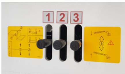
*Palancas de control hidráulico*
