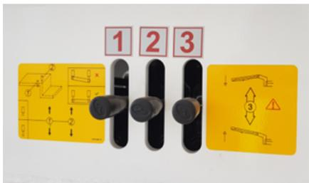
Palancas de control hidráulico
