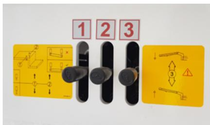
Palancas de control hidráulico
