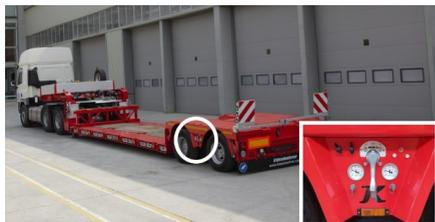
Posición de la válvula de descenso - elevación en el vehículo de plataforma baja
