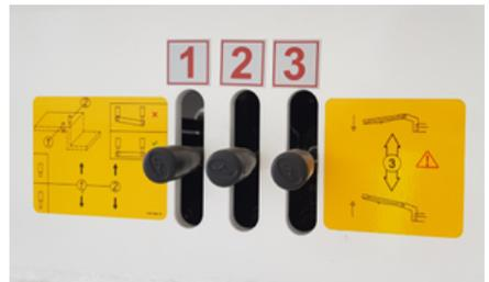
*Palancas de control hidráulico*
