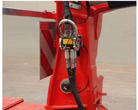
*Acoplamiento rápido hidráulico múltiple*
