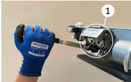
*Conexión de acoplamiento Duomatic*
