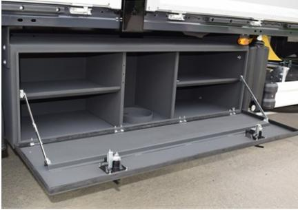
**Algunos armarios pueden tener un estante deslizante. Puede tirar de la balda corredera hacia usted abriendo el mecanismo de cierre de la balda corredera. Después de cerrar el estante deslizante, debe quedar bloqueado.**
