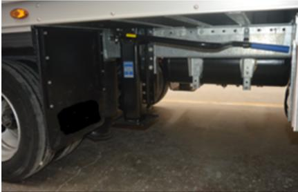
*Pata mecánica trasera de tipo fijo*
