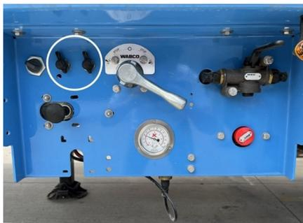
Botón de seta de elevación del eje en el armario eléctrico
