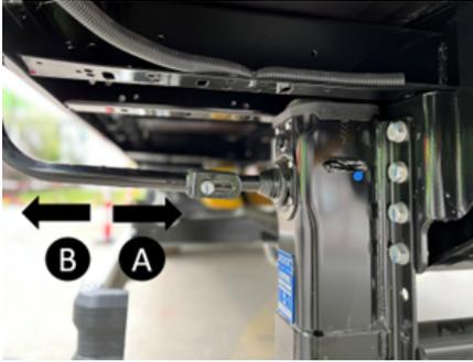
La palanca mecánica de giro de la pata suele estar situada en el lado del pasajero del vehículo.
