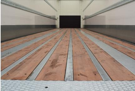
Laminiertes Holz + Stahl Omega
