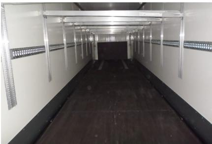
*Schienentyp Doppelboden und Profile*
