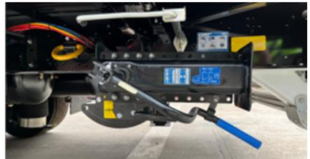
*Klappbare hintere Absattelstütze*
