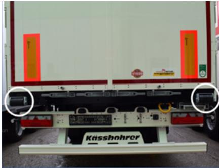
*Unterlegkeile für Rampen*
