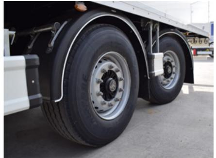
*Mechanisch gelenkte Hinterachse*
