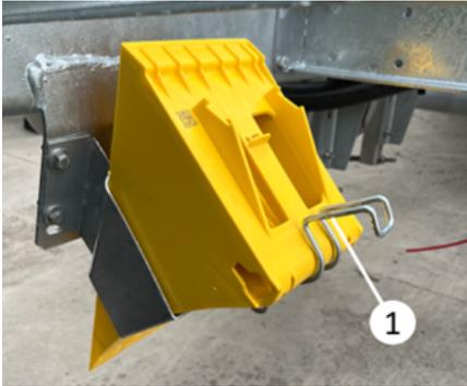
**Entfernen des Keils aus dem Gehäuse:** Entfernen Sie den Keil, indem Sie den Griff (1) am Ende des Keilhalters vom Unterlegkeil wegdrücken.
