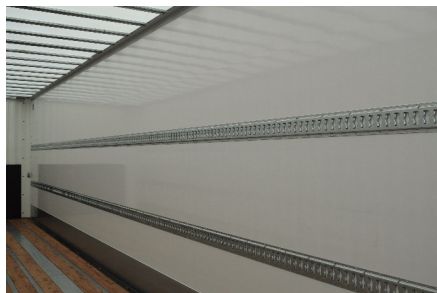
Railes de aseguramiento de la carga
