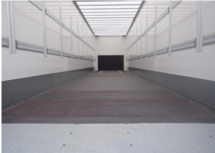
Doble piso tipo raíl
