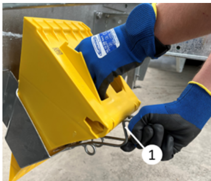
Extracción del calzo de la carcasa
