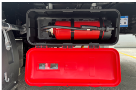
Apertura del armario de extintores
