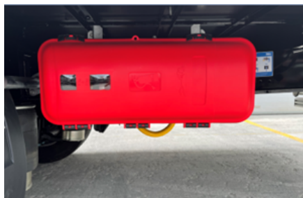
Armario para extintores
