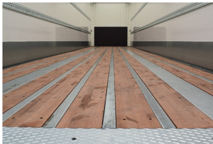
Madera laminada + Omega de acero
