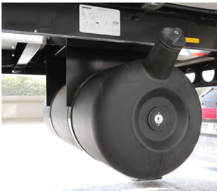
Depósito de gasóleo de plástico
