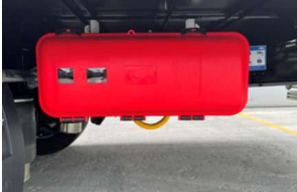
Armario para extintores
