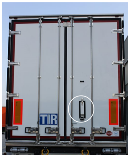
Trampilla de ventilación
