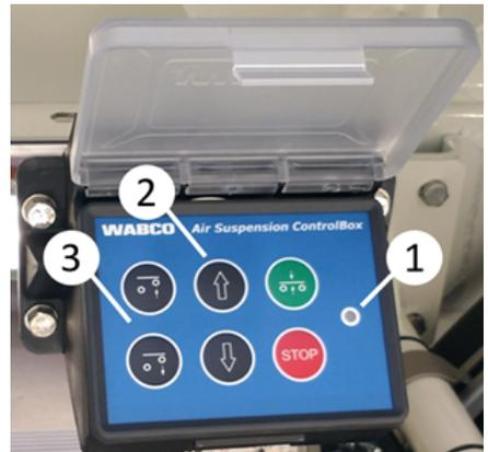
Hebevorrichtung für die Achse
