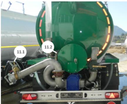
*Mechanisch gesteuertes Absperrventil*
