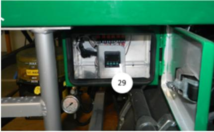
*Elektronisches Zählersystem für die Zentralschmierung*
