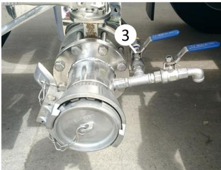
Pneumatische Abblasvorrichtung mit Düsenluft
