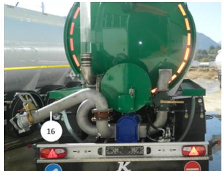
*Auslassleitung der Druckpumpe*
