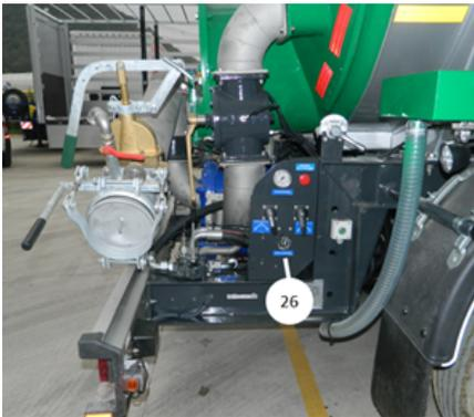
*Manometer für Druckluftaufbereiter*
