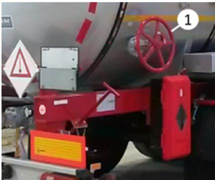
Handrad zum Öffnen des Bodenventils
