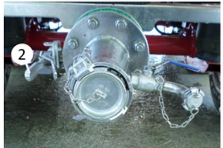
8. Nach dem Entleeren das Bodenventil schließen. Schließen Sie die Schachtabdeckung.
