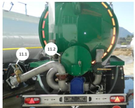
*Mechanisch gesteuertes Absperrventil*
