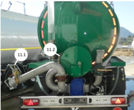
*Mechanisch gesteuertes Absperrventil*
