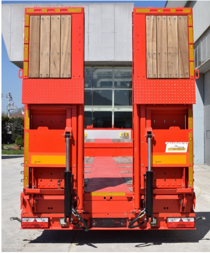
Rampa de suelo de madera dura
