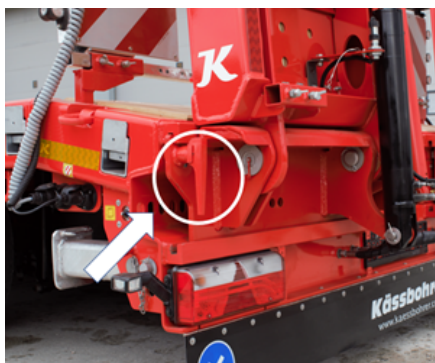
Bloqueo de seguridad de la rampa
