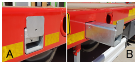
Soportes de ampliación
