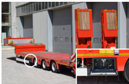
Ubicación del armario de control en el vehículo de plataforma baja
