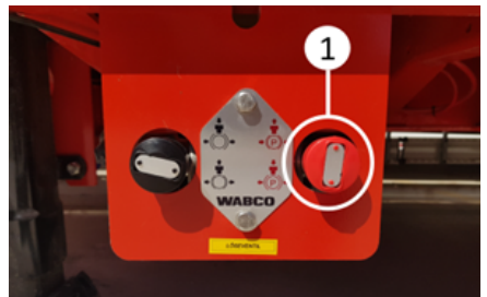
Freno de estacionamiento accionado por muelle
