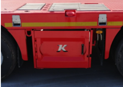
Armario de almacenamiento de rampas
