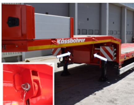
Posición de los pasadores de seguridad
