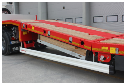
Rampa hidráulica de cuello de cisne
