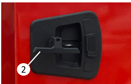
Extracción y giro del pestillo
