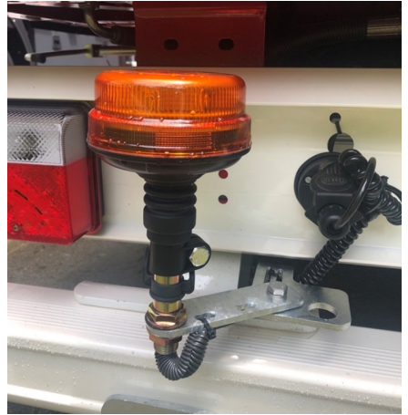
Luz de advertencia giratoria con led
