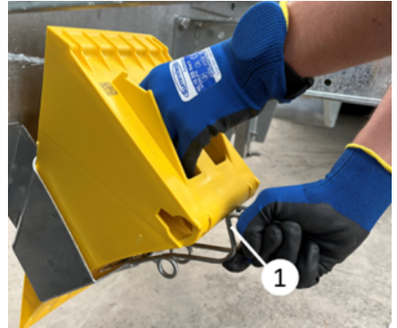
Extracción del calzo de la carcasa
