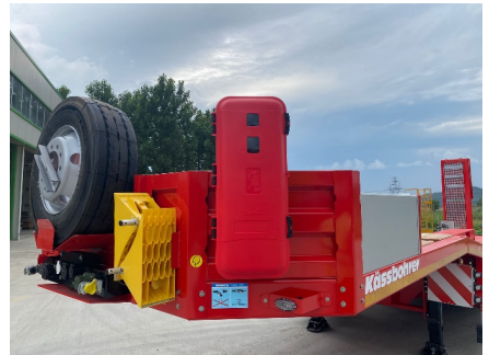
Armario para extintores
