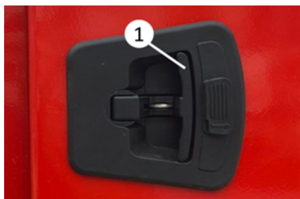
Cerradura y pestillo de la puerta lateral
