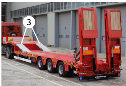
Rampa (3) utilizado en el área de cuello de cisne
