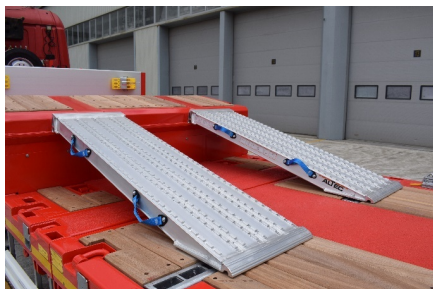
Rampa de aluminio utilizado en la zona de cuello de cisne
