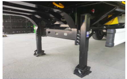
Postura de la pata mecánica
