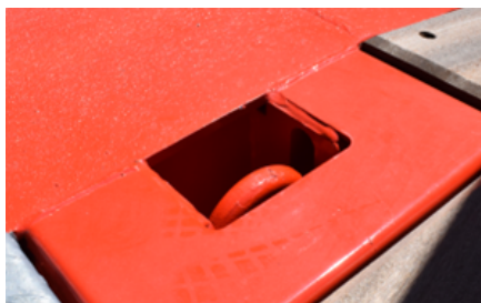
Anillo de aseguramiento de la carga enterrado
