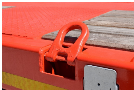
Anilla de aseguramiento de la carga lateral
