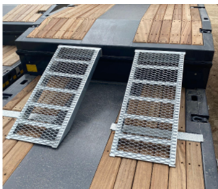
Rampas portátiles de acero galvanizado
