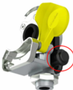
Acoplamiento de palma con punto de prueba
