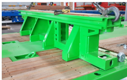
Mesa de transporte con bloqueo de contenedor
