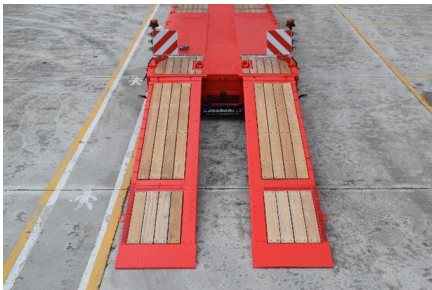
Rampa de suelo de madera dura
