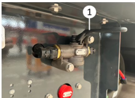
Válvula de desbloqueo del eje orientable
