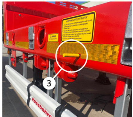
La palanca indicadora sale de la ranura
