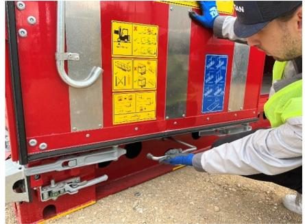
Ein Hin- und Herschwingen der Tür kann zu Unfällen führen. Sichern Sie die geöffnete Tür immer mit dem Türbefestiger. Fahren Sie nie mit geöffneter Tür. Sichern Sie die Tür vor dem Start.
