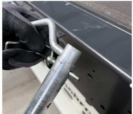
*Sicherungsstift der Schiebedach-Zugstange*
