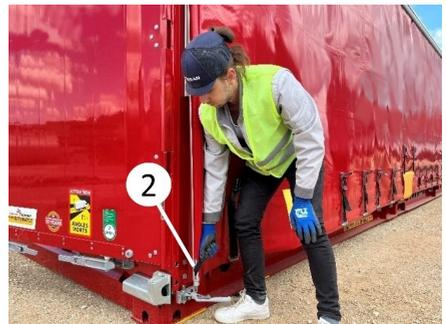
*Entfernen des Vorhangprofils*
