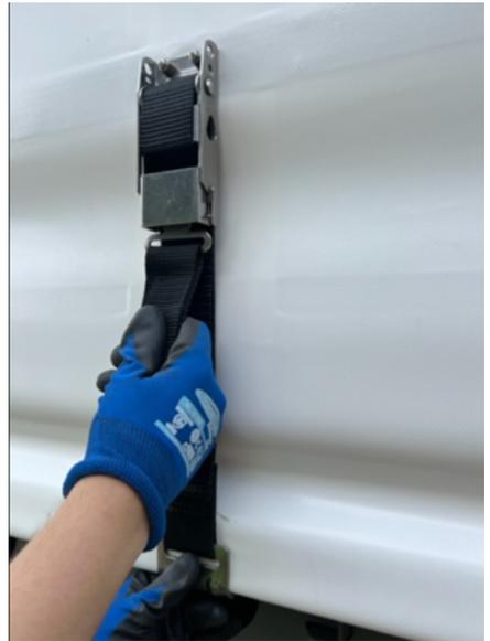
Nach dem Öffnen des Verschlusssystems entfernen Sie den Haken aus dem Außenrahmen oder dem Türing
