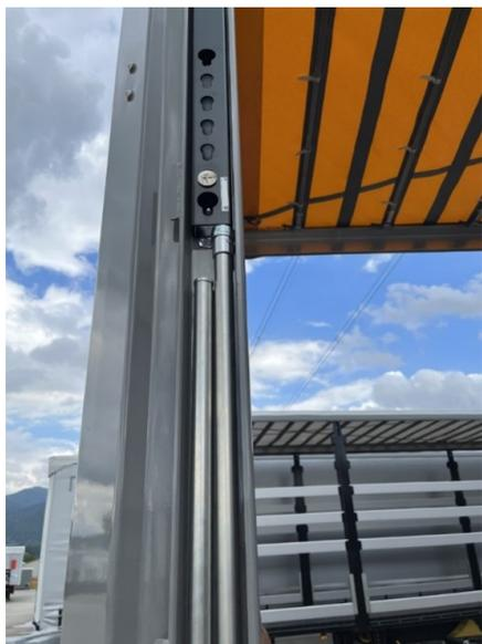
*Barra de nivel de elevación del techo*
