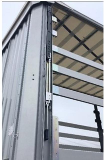
*Bomba de elevación del techo*
