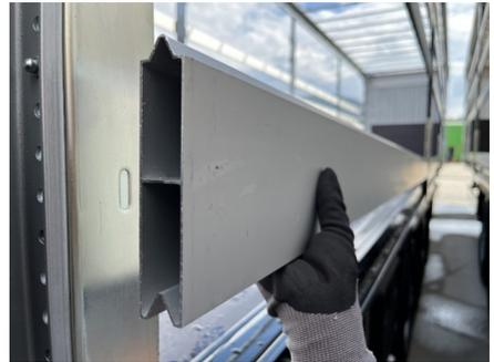
*Estructura lateral de aluminio tipo V*
