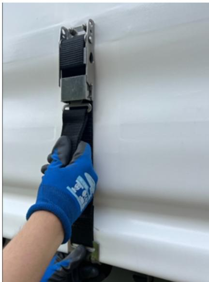
Una vez abierto el sistema de bloqueo, retire el gancho del marco exterior o del anillo de cobertura
