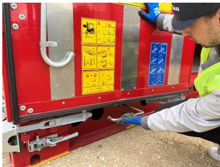
Dejar que la puerta oscile hacia delante y hacia atrás puede provocar accidentes. Asegure siempre la puerta abierta con el cierre de la puerta. No conduzca nunca con la puerta abierta. Asegure la puerta antes del despegue.
