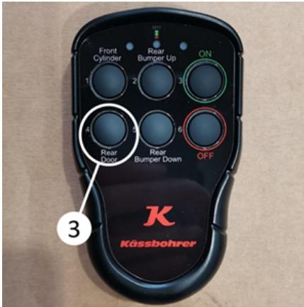
Sie können die Klappe schließen, indem Sie die Taste (3) mit der Aufschrift "Hecktür" auf dem Steuergerät drücken.
