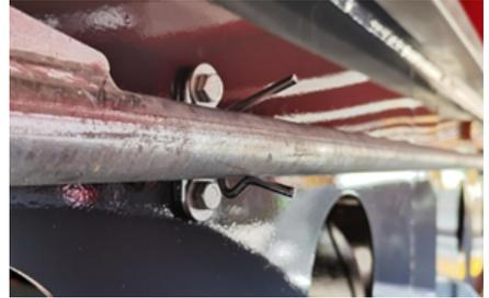
Nehmen Sie mit der Stange die auf der Plane neben der Mulde verbleibende Seile und befestigen Sie sie an den Haken.
