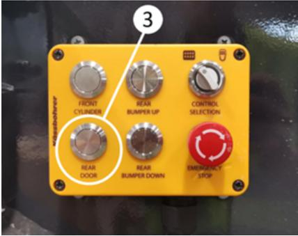
Sie können die Klappe durch Drücken der Taste (3) mit der Aufschrift "rear door" auf dem Steuergerät schließen.
