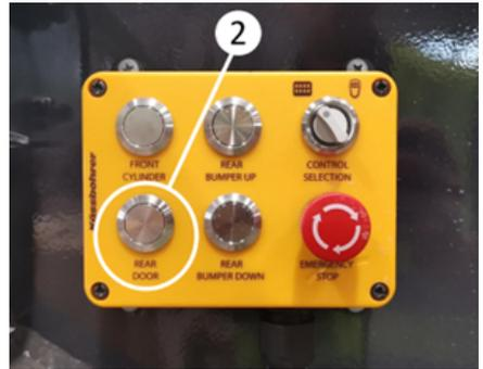
Sie können die Tür öffnen, indem Sie die Taste (2) mit der Aufschrift "Hintere Tür" an der Steuereinheit drücken.
