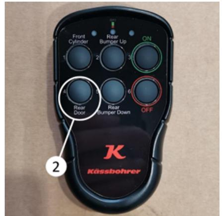
Sie können die Tür öffnen, indem Sie die Taste (2) mit der Aufschrift "Hintere Tür" auf der Fernbedienung drücken.
