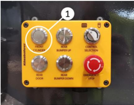
Absenken der Wanne durch Drücken der vorderen Zylindertaste
