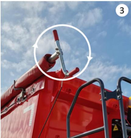
Wenn die Plane die andere Seite der Wanne erreicht hat, sollte sie mit den Seilen an der Plane an den genieteten Haken an der Wanne befestigt werden, wie in Abbildung 4 dargestellt. Wenn Sie die Plane öffnen wollen, kehren Sie diese Schritte um.
