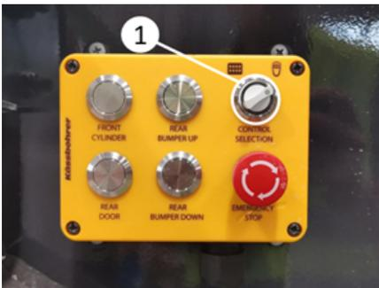
Wählen Sie die Fernbedienung über die Steuerungsauswahl taste (1), wie in der Abbildung gezeigt.
