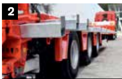
2 Boczne wsporniki poszerzeń
