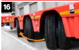
16 Hydrauliczna oś skrętna
