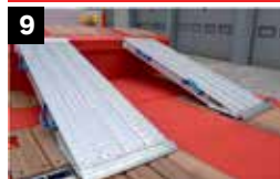
9 Rampa załadunkowa na gęsiej szyi
