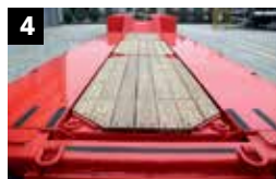
4 Odłączana podłoga z twardego drewna
