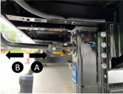
**Hohe Geschwindigkeit (B):** Führt das Heben/Senken mit hoher Geschwindigkeit durch, wenn der Hebel in die vollständig ausgefahrene Stellung gebracht wird. Diese Stellung dient zum schnellen Absenken der FüÙe, bis die Fußschuhe (Platten) den Boden berühren, wenn der Sattelanhänger von der Abschleppwagen abgekoppelt wird, oder zum schnellen Anheben der FüÙe nach dem Ankuppeln des Aufliegers an die Zugmaschine.
