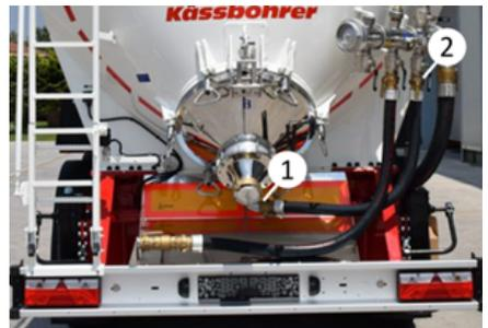
*Fluidisierungsluftleitung und Ventil*
