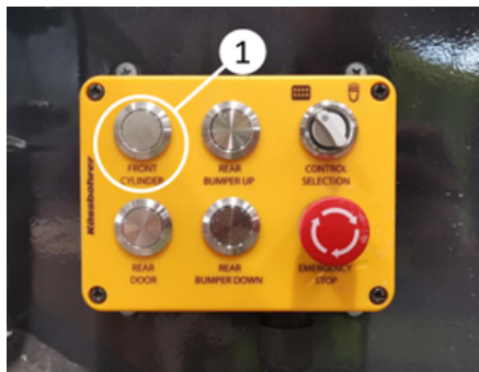
Abaissement de la benne en appuyant sur le bouton Front Cylinder
