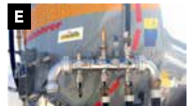
E Collecteur du silo basculant
