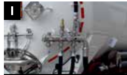
I Lignes d'aération de décharge
