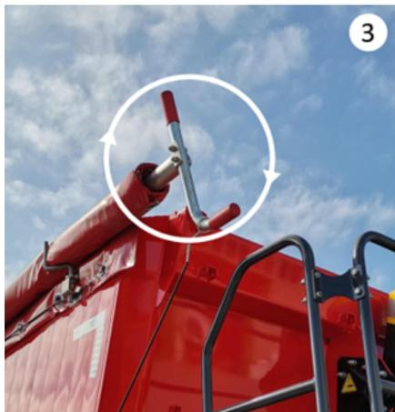
Quando il telone raggiunge l'altro lato della vasca da bagno, deve essere fissato ai ganci rivettati sulla vasca da bagno con le corde del telone come mostrato nella figura 4. Quando si vuole aprire il telo, si deve invertire la procedura.
