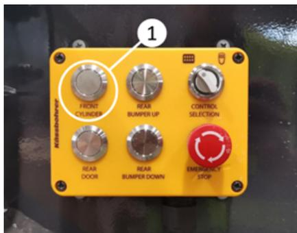
Abbassare la vasca premendo il pulsante del cilindro anteriore
