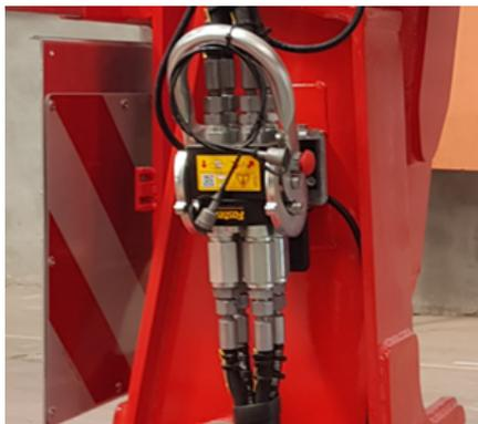
*Collegamento idraulico del giunto rapido*
