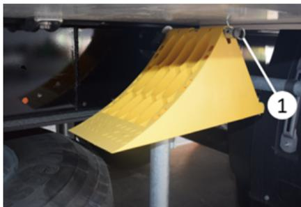
**Inserimento del cuneo nella fessura:** Dopo l'uso, inserire il cuneo nel perno del supporto del cuneo e fissarlo inserendo la coppiglia in posizione.
