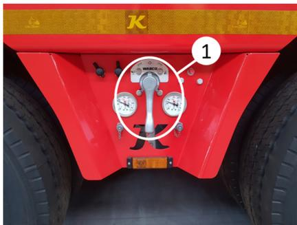
*Posizione di guida delle sospensioni pneumatiche con comando manuale*
