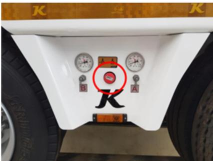
Pannello di controllo del freno di stazionamento
