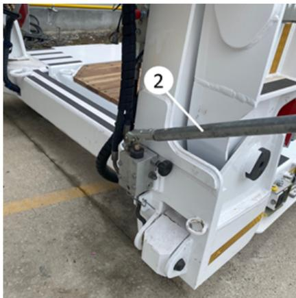
*Da utilizzare come impugnatura della pompa quando si utilizza la pompa manuale di emergenza (2)*
