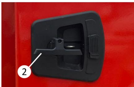
Rimozione e rotazione della chiusura di sicurezza
