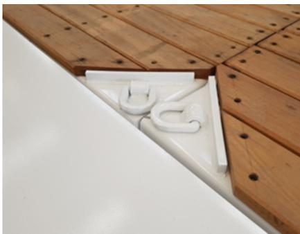
*Anelli di fissaggio del carico*
