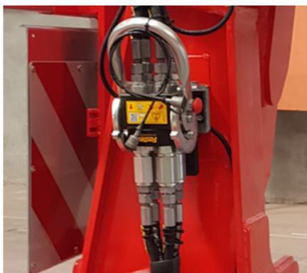
*Collegamento idraulico a innesto rapido*
