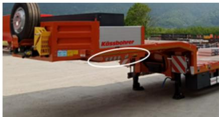
*Posizione della leva della valvola idraulica*
