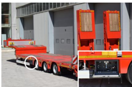
*Posizione dell'armadio di comando nel veicolo a pianale ribassato*
