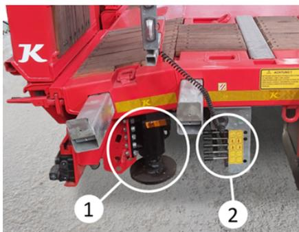
*Gamba di supporto posteriore idraulica e blocco valvola a leva*
