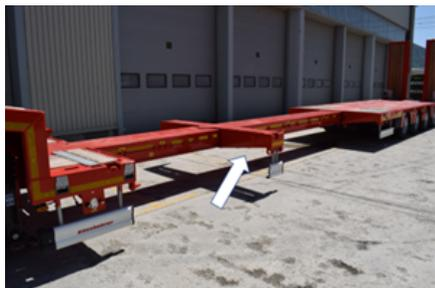
*Posizione del perno di bloccaggio*
