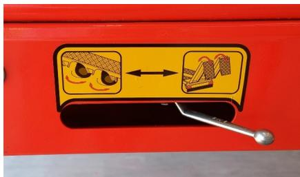
*Posizione della rampa del braccio della valvola idraulica*
