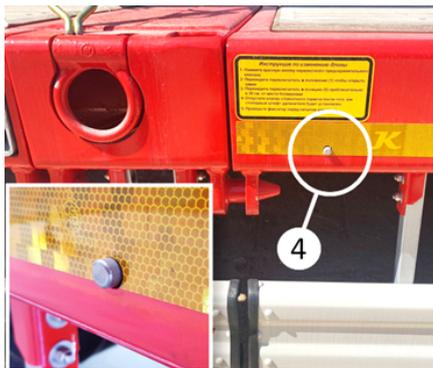
Inserimento della leva di segnalazione nell'alloggiamento
