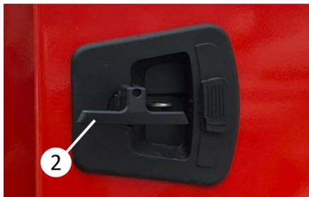
Rimozione e rotazione della chiusura di sicurezza
