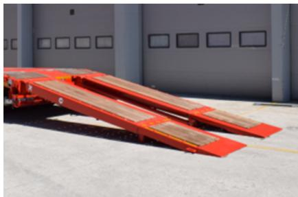
*Rampa idraulica abbassata*
