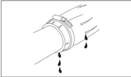
Perdite d'olio nelle connessioni idrauliche e pneumatiche
