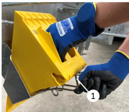
*Rimozione del cuneo dall'alloggiamento*
