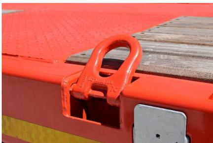
*Anello di fissaggio del carico laterale*
