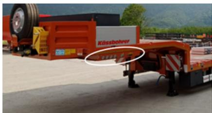
*Posizione della leva del distributore idraulico*
