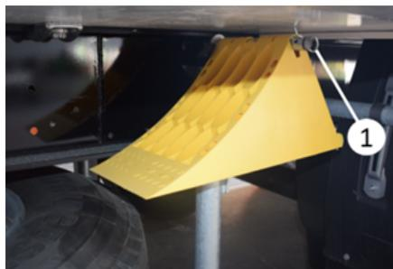
**Inserimento del cuneo nella fessura:** Dopo l'uso, inserire il cuneo nel perno del supporto del cuneo e fissarlo inserendo la coppia in posizione.
