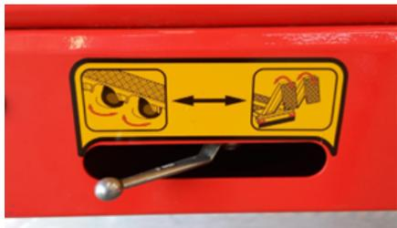
*Posizione di sterzo della leva della valvola idraulica*
