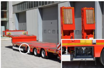
*Posizione dell'armadio di comando sul veicolo a pianale ribassato*
