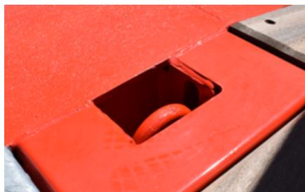
*Anello di fissaggio del carico interrato*
