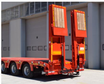
*Stato di sollevamento della rampa idraulica*
