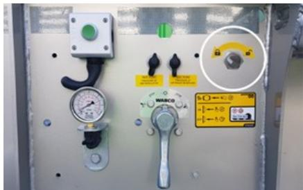
Interruttore di bloccaggio dell'asse sterzante
