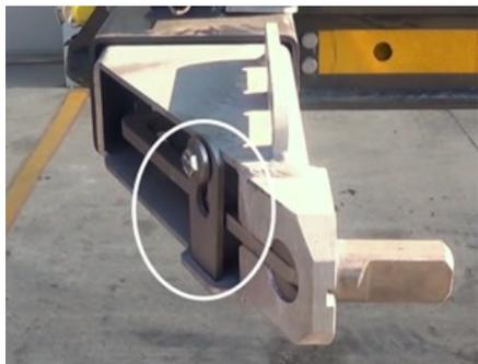
*Fissare la leva di blocco*
