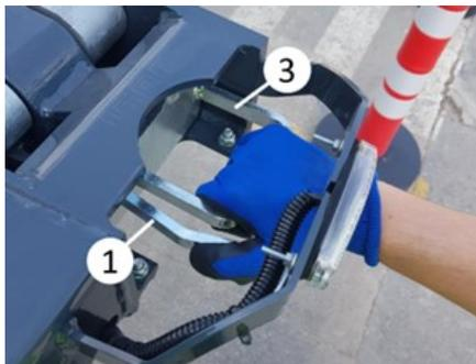
*Premendo il blocco e tirando la leva*
