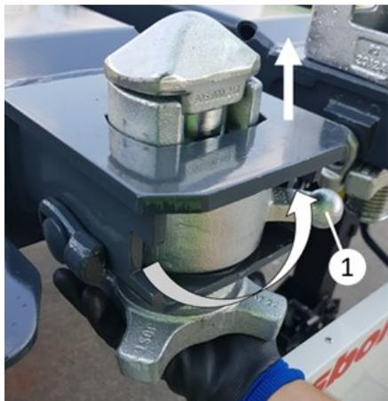
*Rimozione del dado di tensione*
