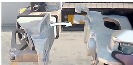
*Rimozione del meccanismo di blocco del container*
