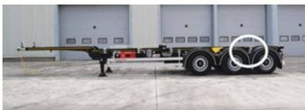
*Posizione del pannello di controllo dell'allungamento posteriore*
