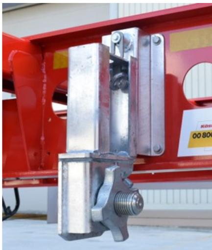
*Vista del meccanismo di chiusura del contenitore inserito nella fessura di immagazzinamento*
