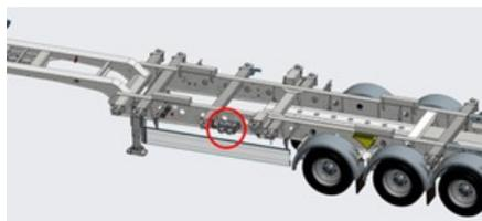
Posizione dell'armadio di stoccaggio del cuneo di bloccaggio
