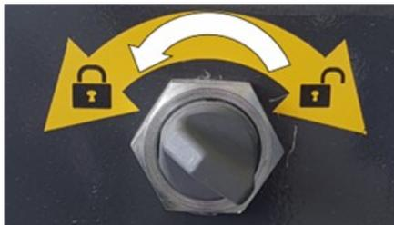
Posizione di blocco della chiave sull'asse sterzante
