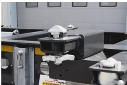
*Montaggio del blocco sulla superficie superiore*
