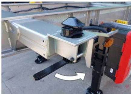
*Rotazione della bloccaggio del contenitore*
