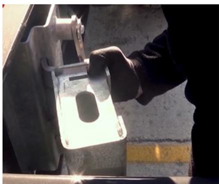
*Inserimento del meccanismo di blocco del contenitore nella fessura di stoccaggio*
