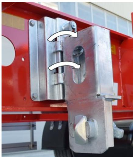
*Rotazione del meccanismo di blocco del contenitore*
