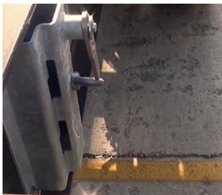
*Fessura di stoccaggio della blocco del container*
