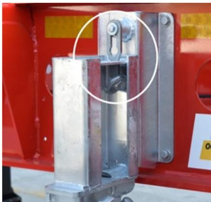
*Inserimento del perno di sicurezza della fessura di stoccaggio*
