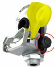
Giunto a "palm" con giunto di prova
