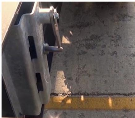
*Fessura di stoccaggio del blocco del contenitore*
