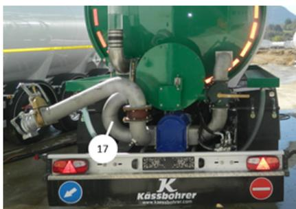
*Linea di ingresso della pompa di miscelazione della cisterna*
