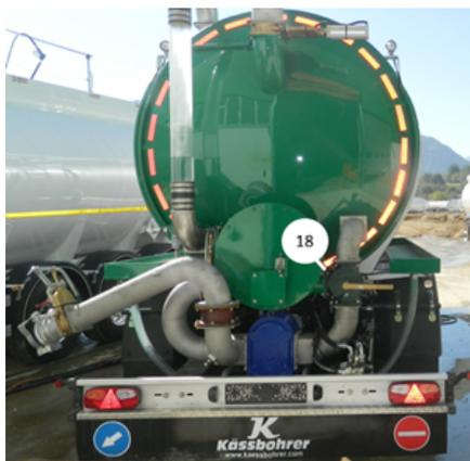
*Linea di ingresso della pompa di scarico*
