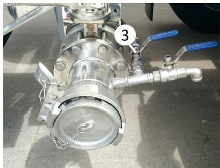
Dispositivo di soffiaggio pneumatico dell'aria a getto
