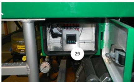
*Sistema di contatore elettronico della lubrificazione centrale*
