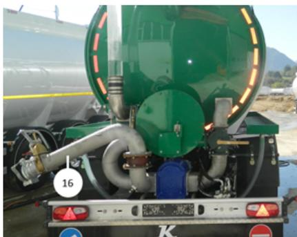
*Linea di uscita della pompa di scarico*
