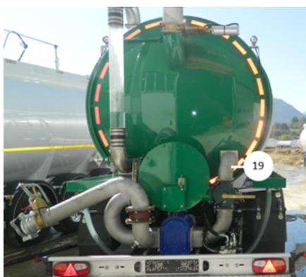
*Linea di uscita della pompa di miscelazione della cisterna*
