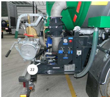
*Leva di comando idraulica*
