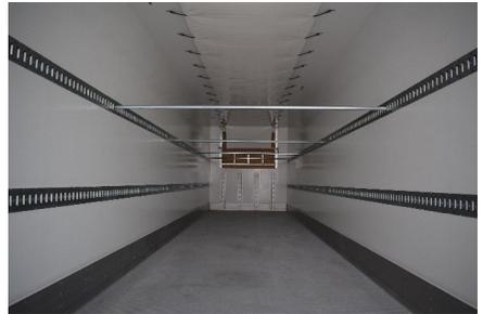
*Profilo di fissaggio del carico di tipo circolare*
