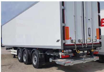
*Sollevatore di tipo pieghevole per il carico posteriore*
