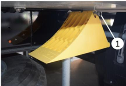
**Inserimento del cuneo nella fessura:** Dopo l'uso, inserire il cuneo nel perno del supporto del cuneo e fissarlo inserendo la coppiglia in posizione.
