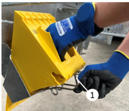
*Rimozione del cuneo dall'alloggiamento*
