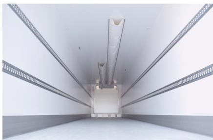
*Condotto di ventilazione di tipo tubolare*
