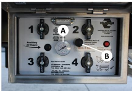
**Manometro (A):** Indica la pressione del sistema in bar.
