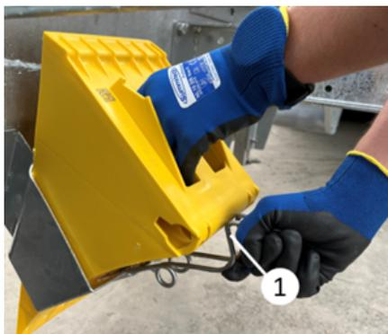
Rimozione del cuneo dall'alloggiamento
