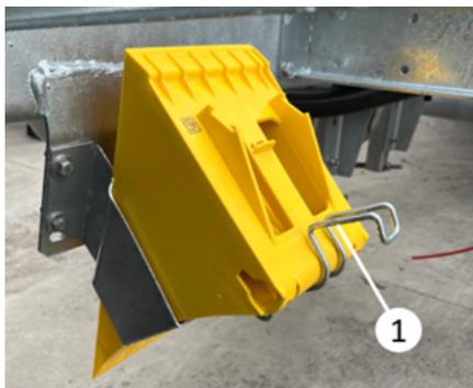
**Rimozione del cuneo per ruote dall'alloggiamento:** Rimuovere il cuneo spingendo la maniglia (1) all'estremità del supporto del cuneo (1) lontano dal cuneo stesso.
