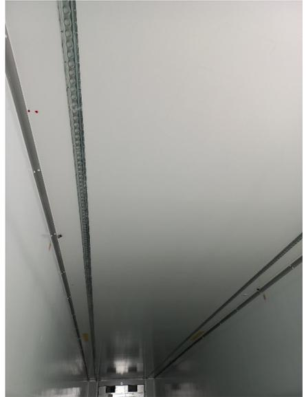
*Binari di fissaggio del carico sul soffitto*
