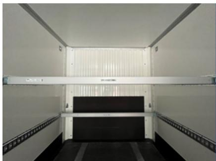
*Profilo di fissaggio del carico di tipo quadrato*
