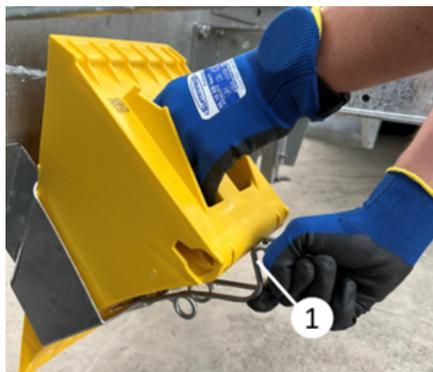
*Rimozione del cuneo dall'alloggiamento*
