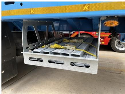
*Alloggiamento portacassetta dissuasori sotto il telaio
