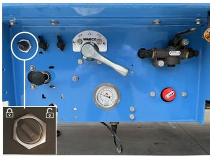
*Chiave per il perno di bloccaggio*
