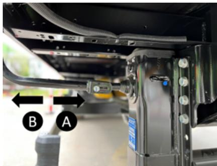
**Alta velocità (B):** Quando la leva viene portata in posizione completamente estesa, si solleva/abbassa ad alta velocità. Questa posizione serve per abbassare rapidamente i piedini fino a quando i pattini (piastre) toccano il suolo quando si sgancia il semirimorchio dal trattore o per sollevare rapidamente i piedini dopo aver agganciato il semirimorchio al trattore.
