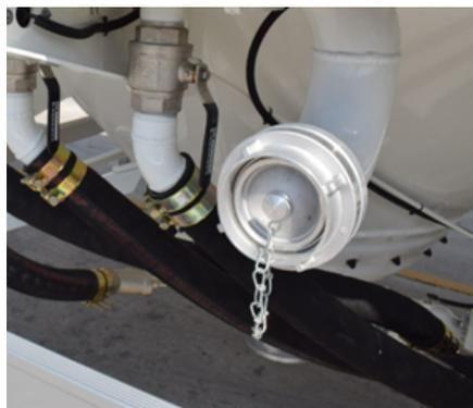
*Tipo di collegamento della linea d'aria laterale*
