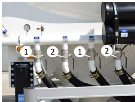
Connessioni dell'aria a getto e dell'aria di fluidizzazione
