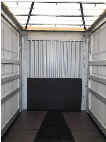
*Struttura in compensato per la protezione dagli urti*
