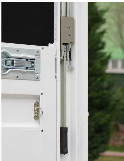
Bomba de elevación del techo
