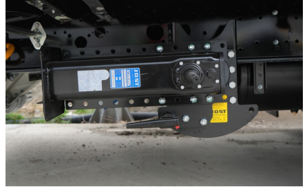
Puesta en servicio de la pata mecánica trasera de tipo plegable
