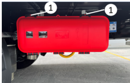
Apertura del armario de extintores
