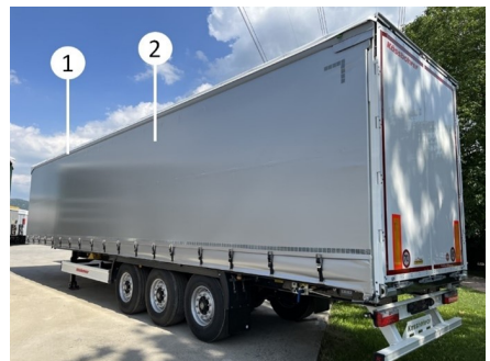
Estructura de cortina sin cubierta sin encolado
