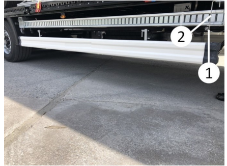
Almacenamiento de las estructuras laterales
