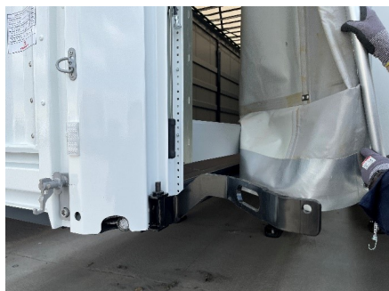
Desmontaje del tubo de la cortina
