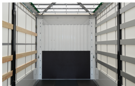
Estructura de madera contrachapada para protección contra impactosa
