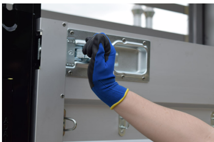
Bloqueo de la cubierta
