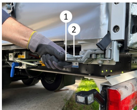
Tensado de la cortina
