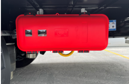
Armario para extintores
