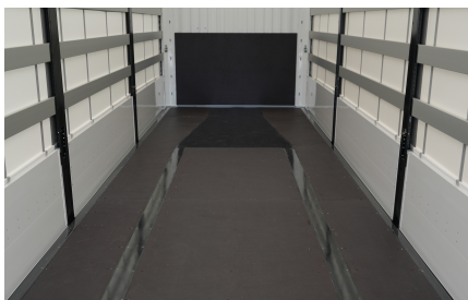
Madera contrachapada recubierta de resina de fenol
