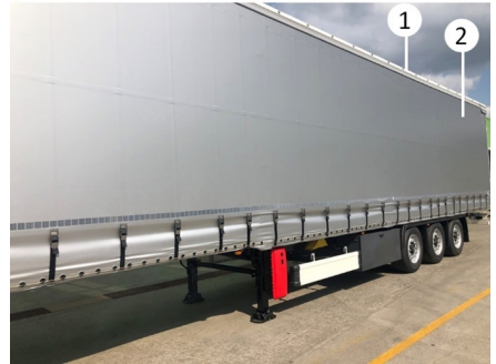
Estructura de cortina sin cubierta encolada
