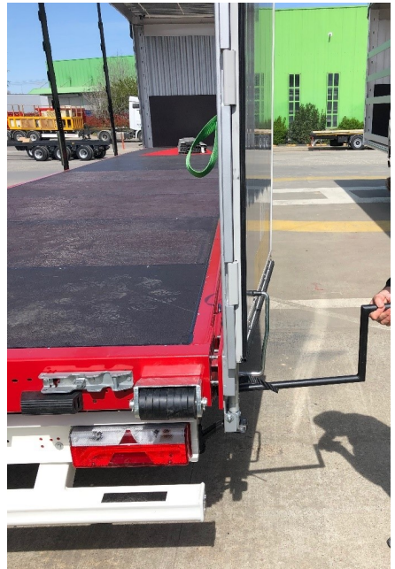
Mécanisme d'expansion du pilier arrière
