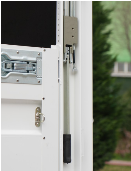
Pompe de levage du toit
