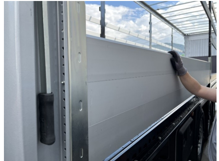
Structure latérale en aluminium de type V superposé
