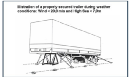
Béquilles pour ferry et connexion RO-RO
