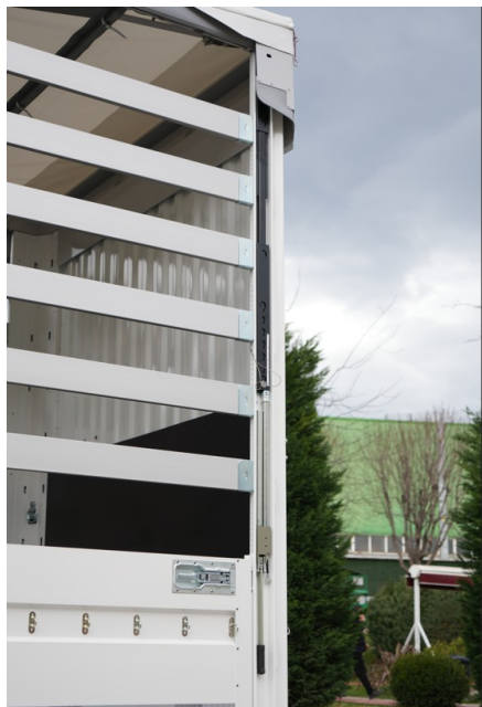
Pompe de levage du toit
