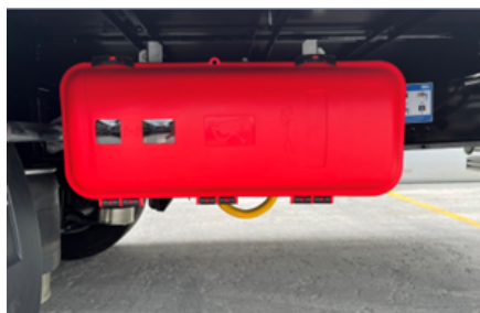
Armoire pour extincteurs
