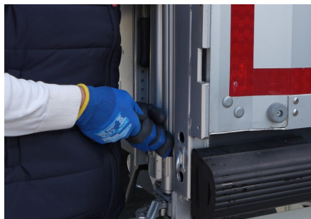
Démontage du profilé de la bâche
