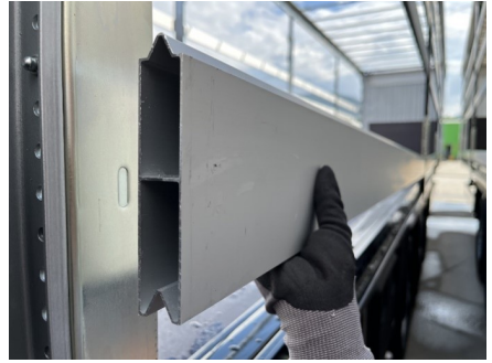
Structure latérale en aluminium de type V
