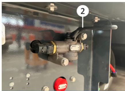
Valve de déverrouillage de l'essieu directeur
