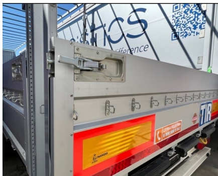
Levier de verrouillage et loquet de sécurité
