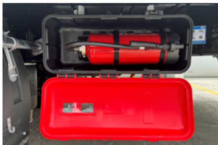
Ouverture de l'armoire à extincteurs
