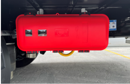
Armoire pour extincteurs
