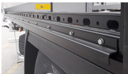
Metalowa bariera do wózka widłowego
