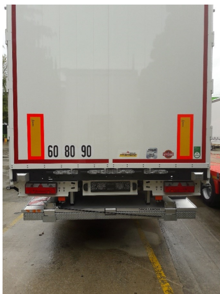
Tylna winda załadowcza typu składanego
