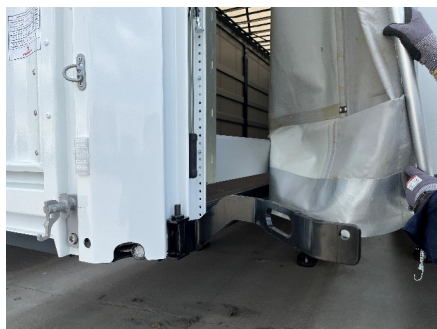
Demontaż rury kurtyny
