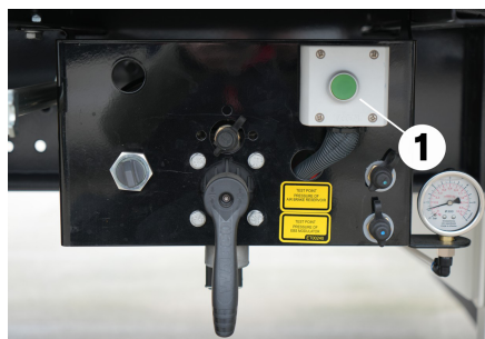
Przycisk sprężynowy na płycie ramienia
