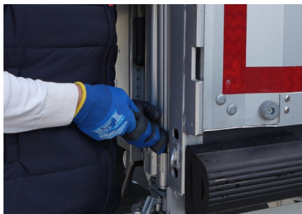
Usuwanie profilu kurtyny
