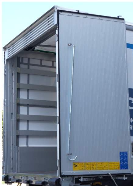
Drążek do ciągnięcia dachu przesuwanego
