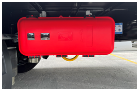
Szafa na gaśnice
