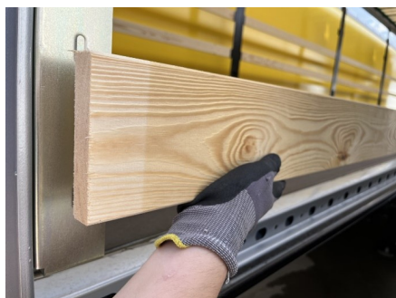
Drewniana konstrukcja boczna
