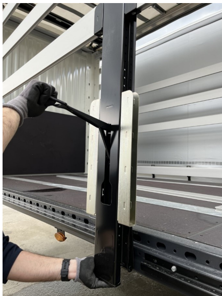
Odblokowanie słupka przesuwanego
