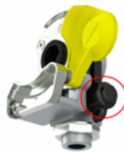
Sprzęg palm z punktem pomiarowym
