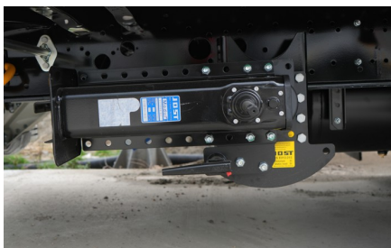
Typ składania Tylna stopa mechaniczna
