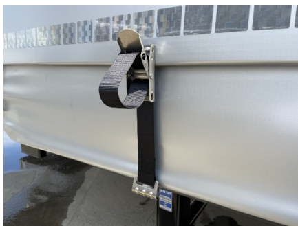
Konstrukcja kurtyny bez osłony
