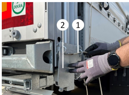
Demontaż liny celnej
