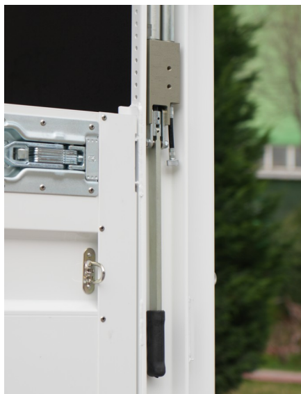
Pompa podnoszenia dachu
