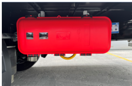
Szafa na gaśnice
