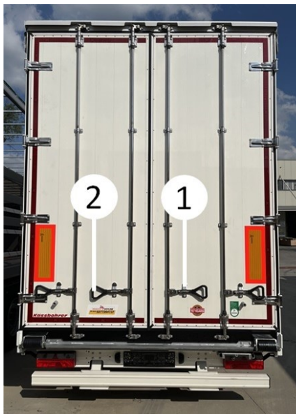
Drzwi typu kontenerowego
