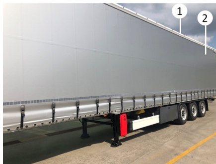
Konstrukcja kurtyny bez osłony celnej
