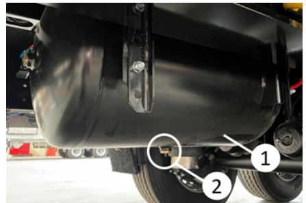
Depósitos de aire
