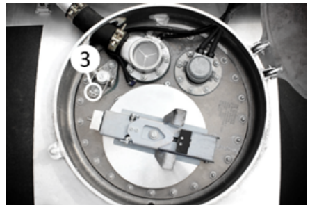
Sellado de la varilla de control de nivel
