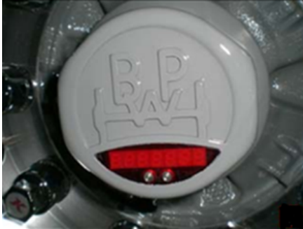
Cuentakilómetros de cubo
