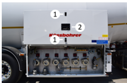
Puerta del armario de armadura
