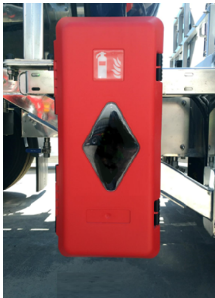
Armoire à extincteur
