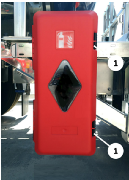
Armoire pour extincteur
