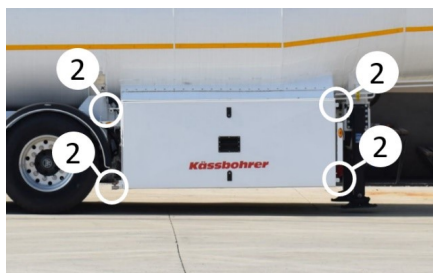
Sigillatura dell'armadio di armatura
