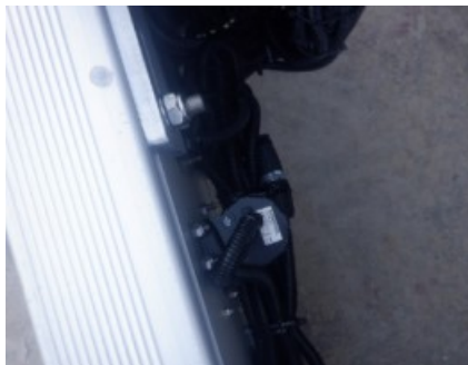
Dźwiękowy System Ostrzegawczy Biegu Wstecznego
