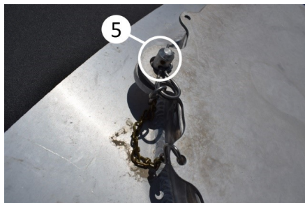
Pokrywa uszczelniająca włazu
