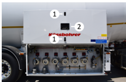
Pokrywa skrzynki armaturowej
