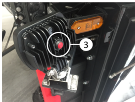
Wyłącznik lampy roboczej
