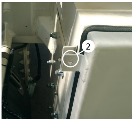
Uszczelnienie skrzynki armaturowej
