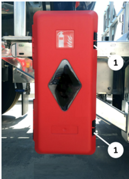
Szafka na gaśnice
