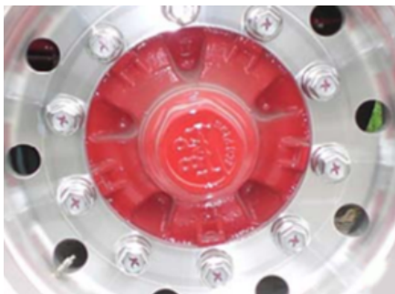
Pokrywy na nakrętkach kół
