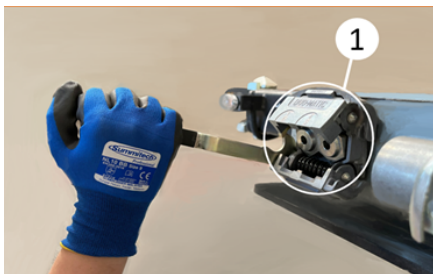
Duamatyczne połączenie sprzęgające
