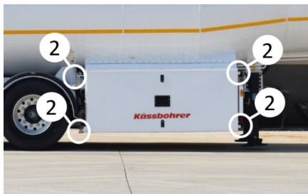
Uszczelnienie skrzynki armaturowej
