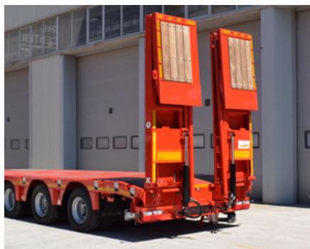
Version levée de la rampe hydraulique
