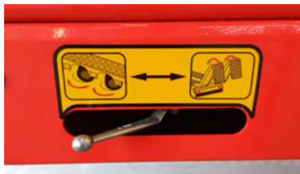
Position de direction du levier de soupape hydraulique
