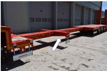
Position de la goupille de verrouillage
