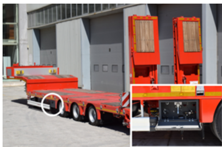
Emplacement de l'armoire de commande sur le véhicule à plate-forme surbaissée
