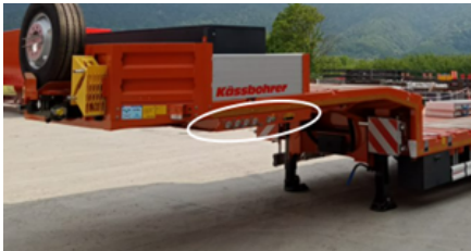
Position du levier de soupape hydraulique
