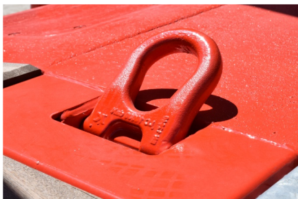
Anneau d'arrimage de la charge enlevé
