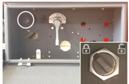
Interrupteur de verrouillage pneumatique
