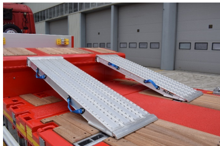
Rampe en aluminium utilisée dans la zone du col de cygne
