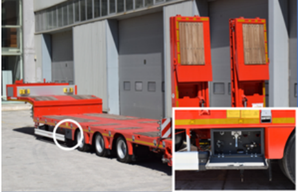
Emplacement de l'armoire de commande sur le véhicule à plate-forme surbaissée
