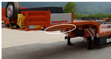
Position du levier de soupape hydraulique
