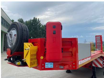
Armoire à extincteurs
