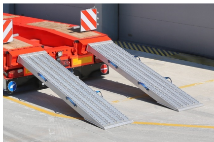
Rampes utilisées dans la zone de pare-chocs
