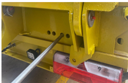
Déplacement de la rampe mécanique à l'aide d'un levier
