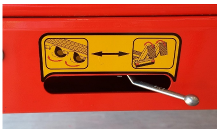
Posición de la rampa del brazo de la válvula hidráulica
