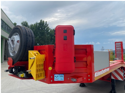
Armario para extintores
