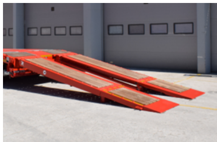
Obniżona wersja rampy hydraulicznej
