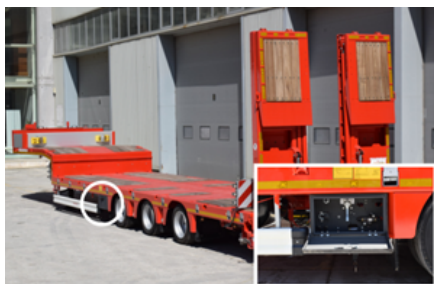
Umieszczenie szafy sterowniczej w pojeździe niskopodwoziowym
