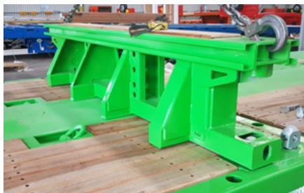
Stojak transportowy z blokadą pojemnika
