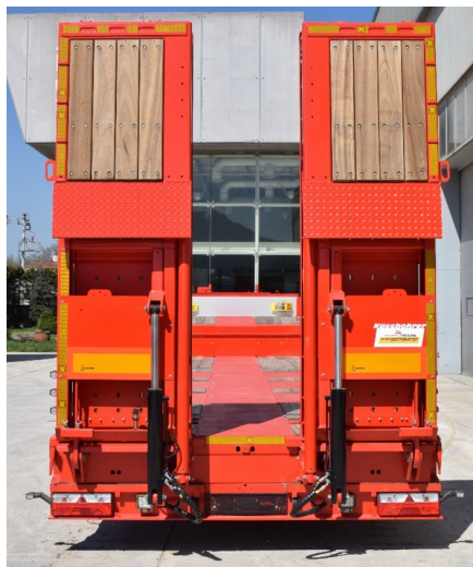
Rampa z twardego drewna
