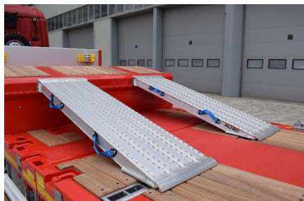
Aluminiowa rampa zastosowana w obszarze gęsiej szyi
