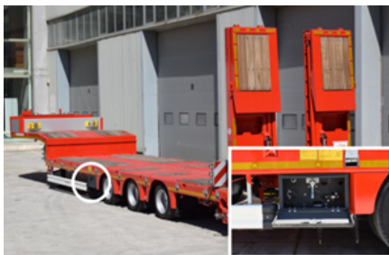
Umieszczenie szafy sterowniczej w pojeździe niskopodwoziowym
