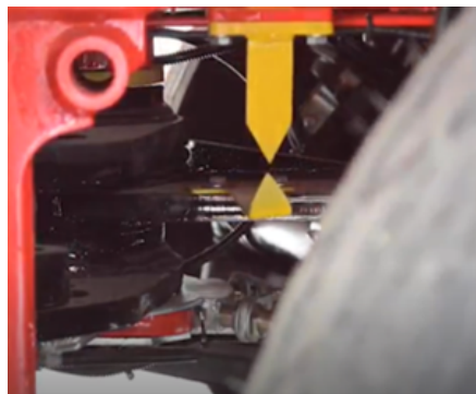
Wyrównanie strzałek wyrównania odniesienia
