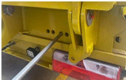
Przesuwanie rampy mechanicznej za pomocą łomu
