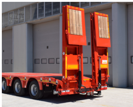
Podniesiona wersja rampy hydraulicznej
