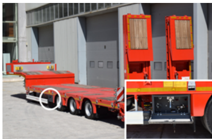
Umieszczenie szafy sterowniczej w pojeździe niskopodwoziowym
