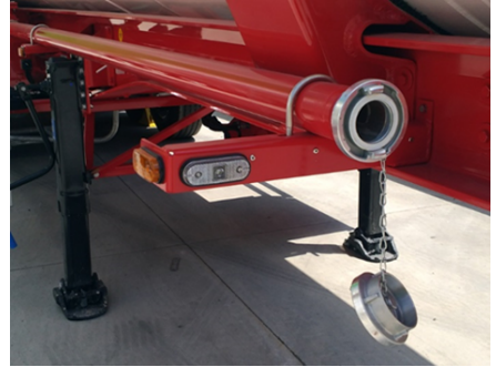
Línea de aire de fluidización
