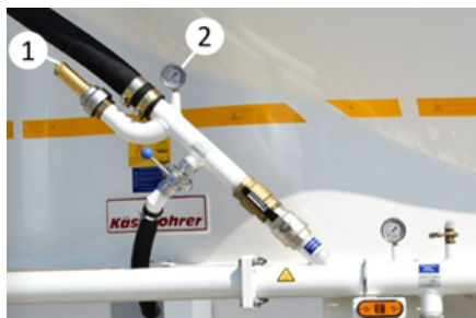
Válvula limitadora de presión y manómetro
