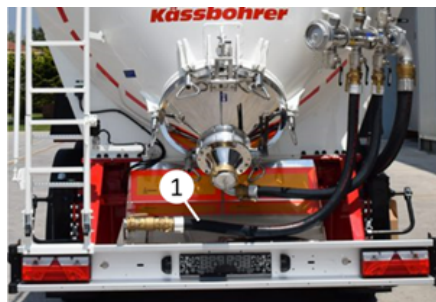
Línea de aire a presión
