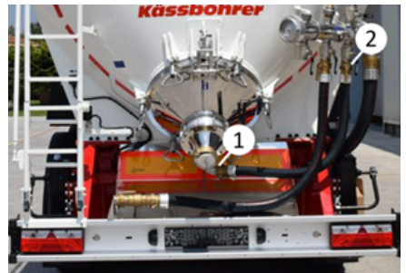
Línea de aire de fluidización y válvula
