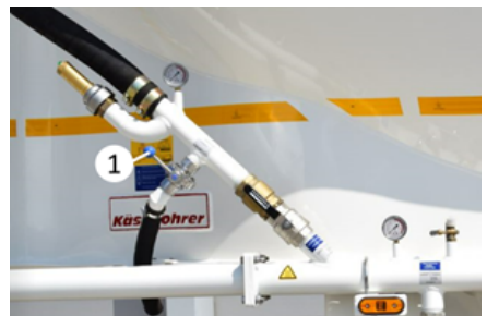
Válvula de escape de aire
