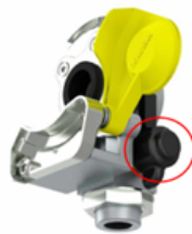
Acoplamiento de palm con punto de prueba
