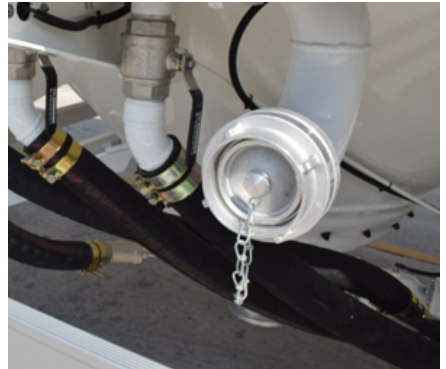
Tipo de conexión de la línea de aire lateral
