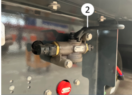
Válvula de desacoplamiento del eje libre
