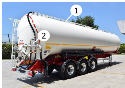
Conduite d'air supérieure
