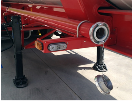
Conduite d'air de fluidisation
