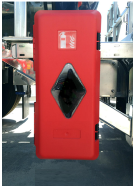
Armoire à extincteurs
