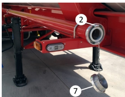
Entrée latérale de la conduite d'air
