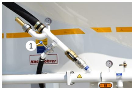
Vanne d'évacuation d'air
