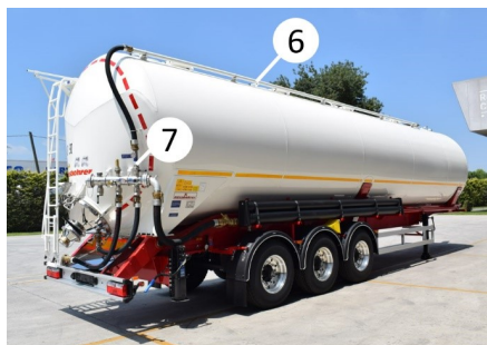
Conduite d'air supérieure
