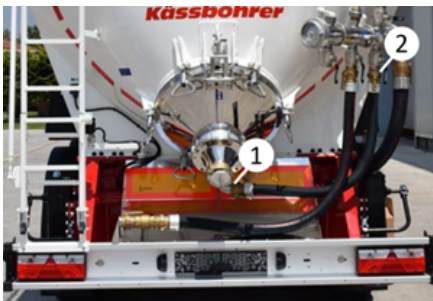
Conduite et vanne d'air de fluidisation
