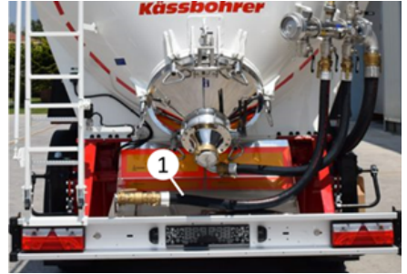
Conduite d'air jet
