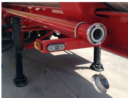
Przewód powietrza fluidyzującego
