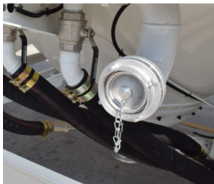
Typ podłączenia bocznego przewodu powietrza
