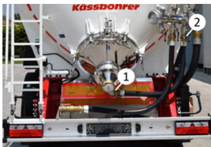
Linia powietrza fluidyzacyjnego i zawór
