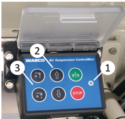
Skrzynka sterująca systemu ECAS
